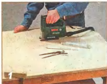
На листе фанеры с помощью самодельного шаблона намечают контуры фигурных деталей, которые вырезают электролобзиком.
