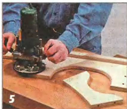
5 Все кромки деталей обязательно закругляют. Для этого используют фрезерную машинку с профильной фрезой и упорным кольцом.
