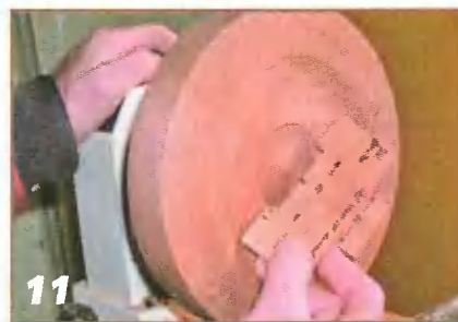
Диаметр внутренней проточки проверяют простым шаблоном.
