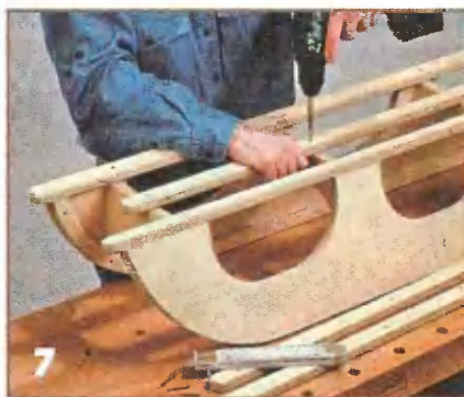
7 Просверлив в рейках сиденья отверстия под шурупы, их крепят к боковинам и поперечным связям. Сначала привинчивают две крайние рейки заподлицо с наружной плоскостью боковин, затем — центральную, а две оставшиеся — между центральной и крайними.
