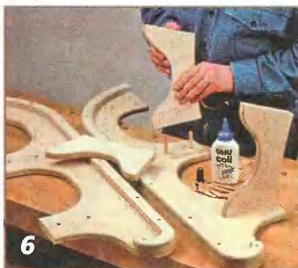
6 Вставив на клею шканты в отверстия боковин, на них, также с клеем, надевают поперечные связи, слегка постукивая сверху молотком. Удары наносят через деревянную прокладку.
