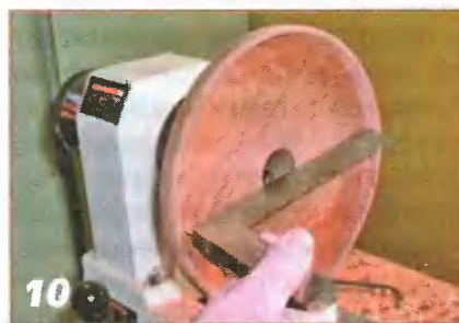
На остановленном станке ребром лезвия угольника проверяют, чтобы крышка была плоской.
