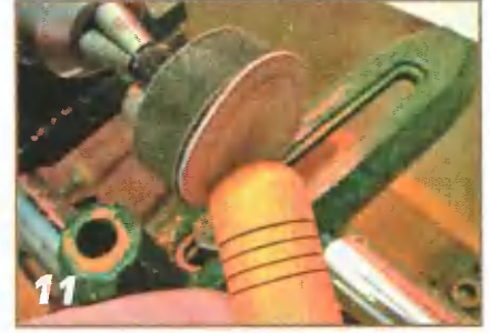
11 Окончательная зачистка на подушке с мелким абразивом.
