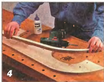
4 Накладки к полозьям крепят на водостойком клее и шурупах заподлицо с нижней кромкой боковин. Если кромки накладок и боковин не совсем точно совпадают, их можно подогнать шлифованием.
