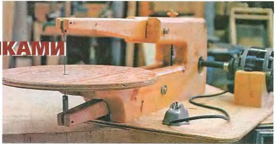
Самодельный лобзик с приводом от старой швейной машинки пилит очень быстро.
