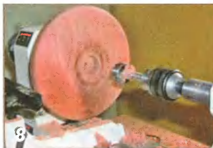
Сверлом Форстнера, зажатым в кулачковом патроне, сверлят отверстие под втулку ножи.
