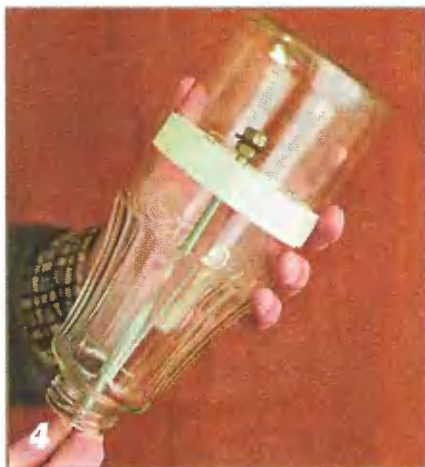
5 Специальный «молоточек» для простукивания линии реза изнутри банки.
