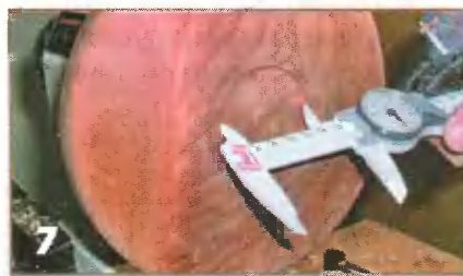
Размер внутренней проточки проверяют штангенциркулем.
